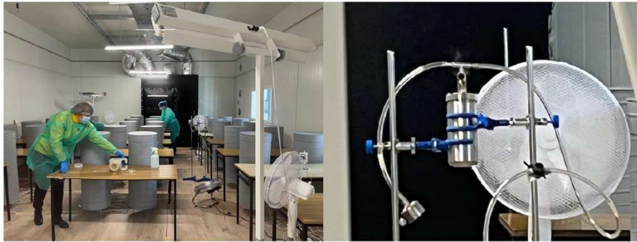
Widok Sali lekcyjnej w czasie badań „Mikrobiologiczna jakość powietrza”. Pobór próbek powietrza w lokalizacjach M1 – M3 (z lewej) oraz dozowanie aerozolu (z prawej)
